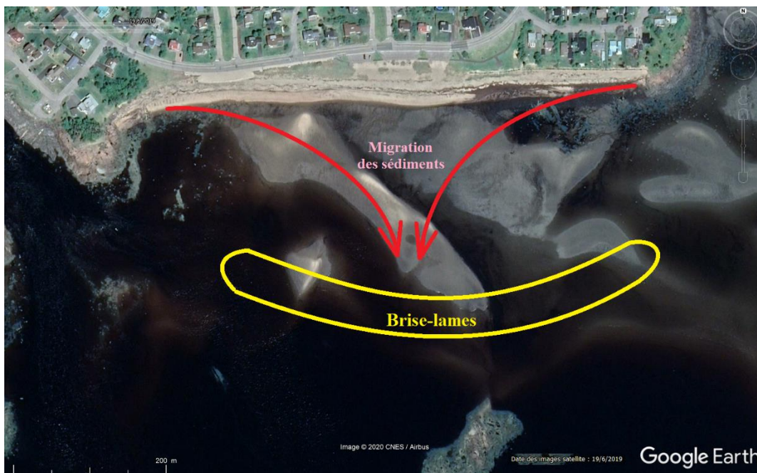
Figure 5.1 Brise-lames détaché – Vue en plan
